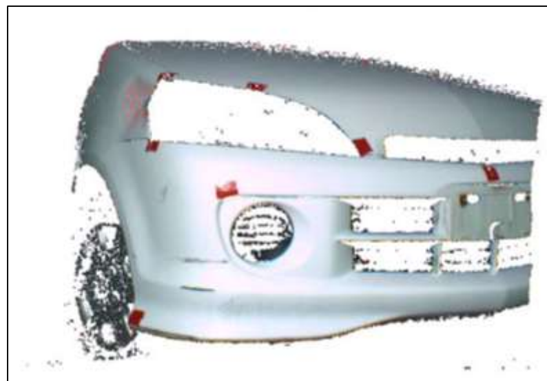
車両の凹み検出(3次元計測)
